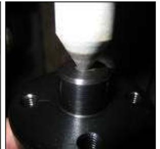
高精度円筒研削に必要なセンターラップ加工
