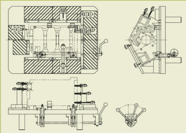
完成したワークの寸法や穴ピッチなどを全て測定することができるインライン用総合ゲージを使えば作業効率が大幅にUPします。
